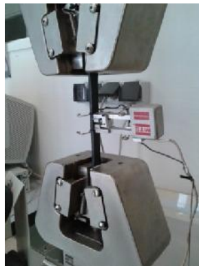
Figure V.1 : Montage de l'éprouvette sur la machine de traction.
