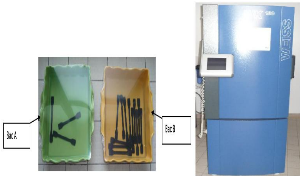
Figure III.4 : Bac pour immerger les éprouvettes et enceinte climatique.
