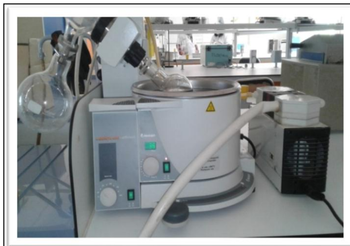
Figure 11: Élimination de dichlorométhane par rotavapeur, (Original, 2020).
