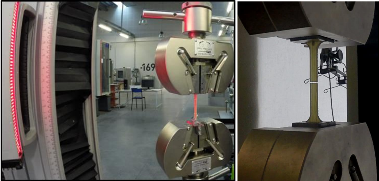
Figure. 44. Test de traction sur une éprouvette bio-composite.
