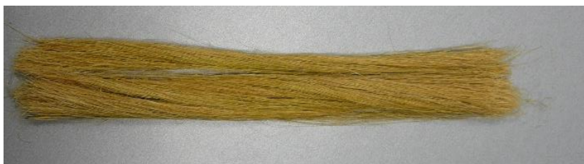
Figure. 20. Fibres extraites à la soude de NaOH (chimiquement).
