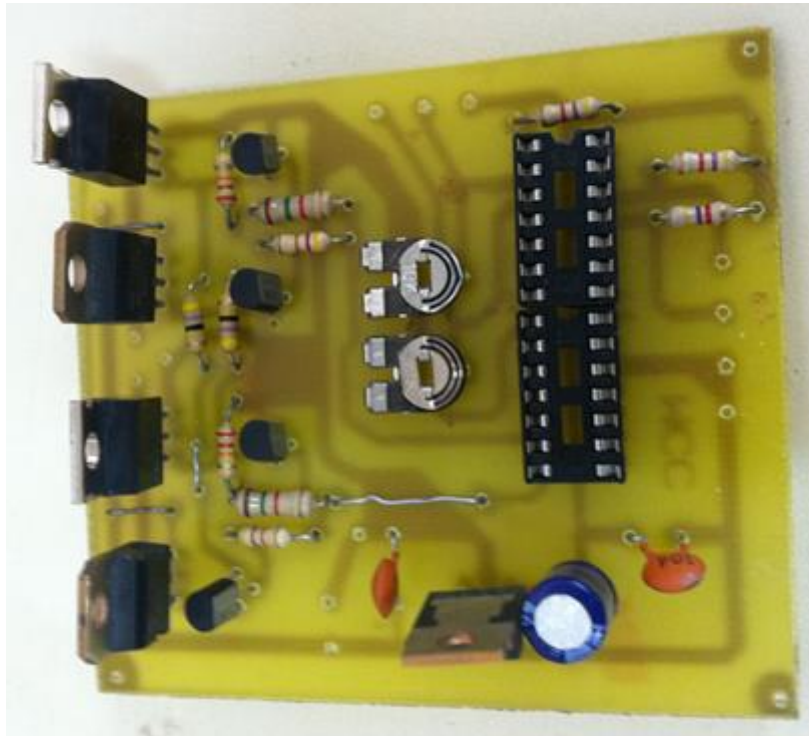
Figure IV-27 : Circuit imprimé du suiveur
