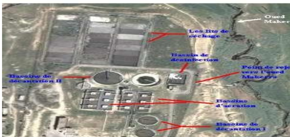
Figure 07 : Photo satellitaire de la STEP de la ville de Sidi bel Abbés. (STEP SBA)
