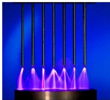
Figure I-2. Aspect lumineux de la décharge couronne dans une configuration multi-pointes [7].
