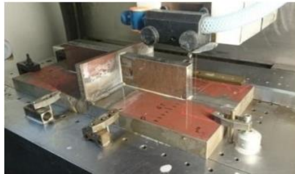
Figure III.5 : Découpe EDM d'un joint soudé en Té [22].
