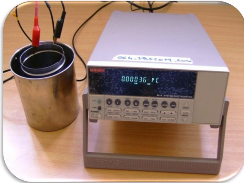
Figure II.14 : Photographie de la cage faraday et l'électromètre 6514
