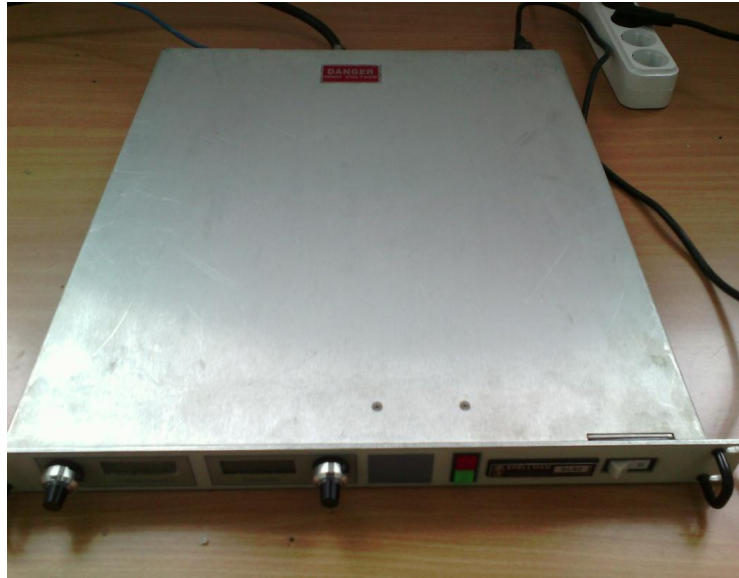
Figure II.8 : Photographie du générateur de haute tension utilisé.
