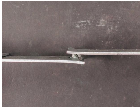
Figure II.30 : Epreuve soudée par point après l'essai de traction de l'acier HSLA 350-1,5mm
