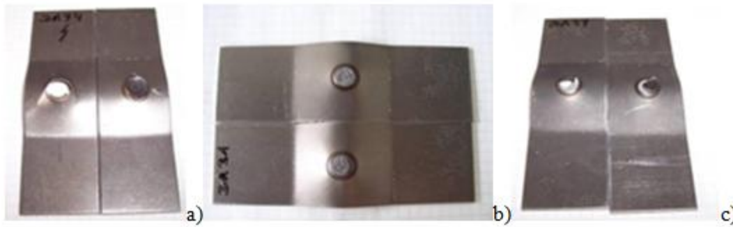
Figure I.11 : Illustrations des modes de rupture en traction en croix dans le cas d'un DP 780 2mm : a) déboutonnage BP, b) rupture totale à l'interface FIF, c) rupture partielle à l'interface PIF
