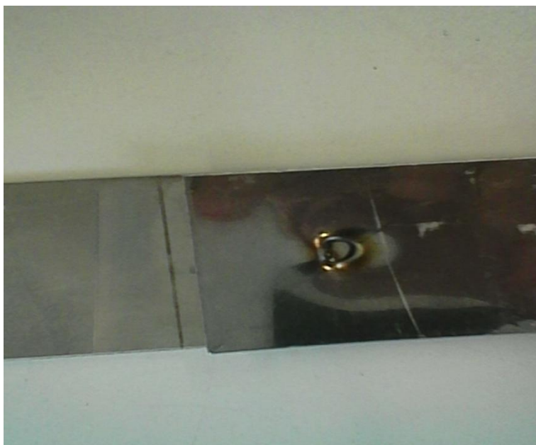
Figure II.28 : Epreuve soudé par point après l'essai de traction de l'acier AISI 430
