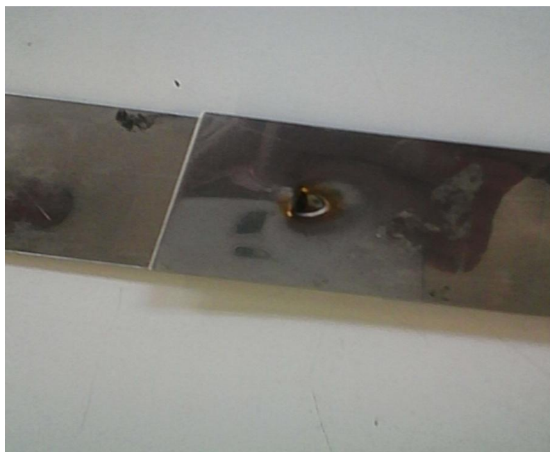
Figure II.27 : Eprouvette soudé par point après l'essai de traction de l'acier AISI 304
