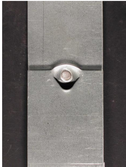
Figure II.30 : Epreuve soudée par point après l'essai de traction de l'acier HSLA 350-1,5mm
