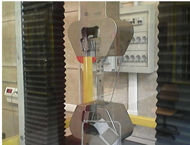
Figure II.26 : Eprouvette soudé par point dans la machine de l'essai de traction
