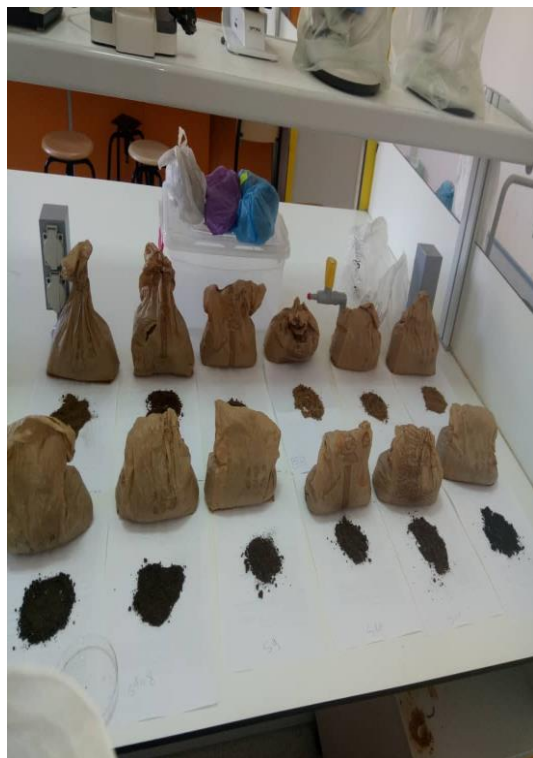
Figure 44 : Séchage du sol
