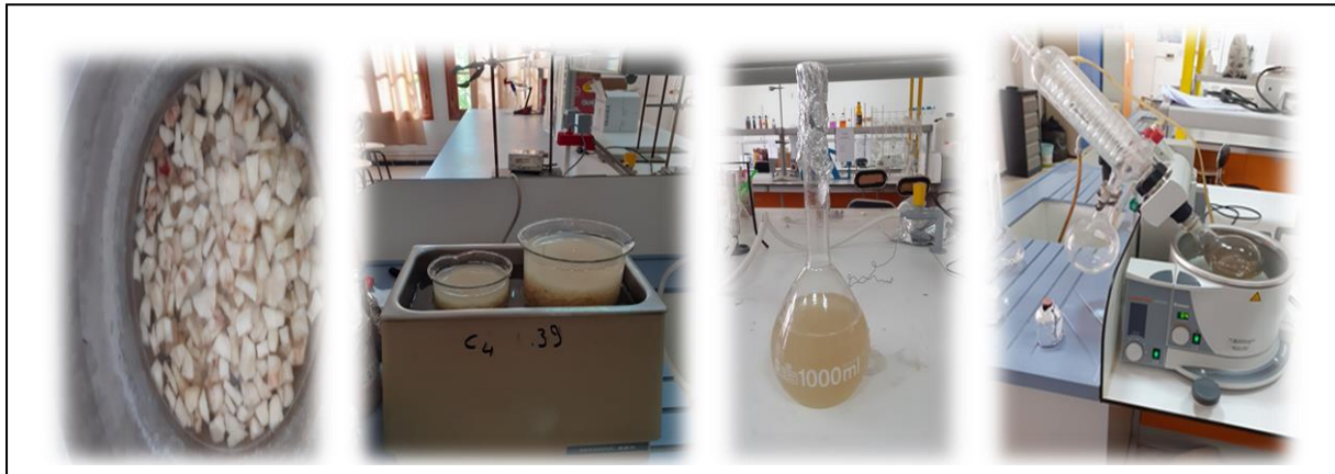
Figure 20 : préparation de l'extrait aqueux après traitement thermique (B)
