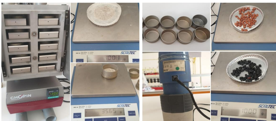
Matériel utilisée dans le dosage d'humidité
