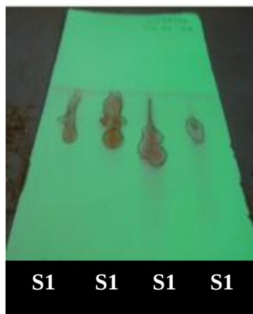
Figure 18 : Chromatogramme de l'éluant butanol / acide acétique / eau
