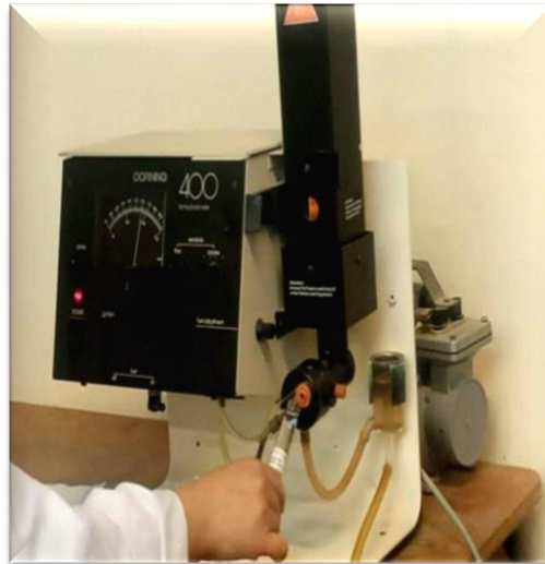
Figure 39: la lecture des minéraux de six variétés de ND au spectrophotomètre atomique
