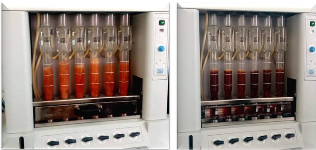
Figure 37: le placement des échantillons dans l'extracteur des fibres
