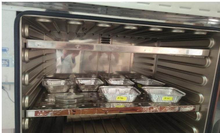
Figure 3.11 Séchage du gingembre dans l'étuve
