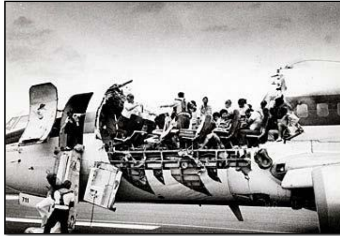
Figure I.20 : Accident de l'Aloha Airlines le 28 avril 1988, sur un Boeing 737 assurant des vols régionaux entre Hilo et Honolulu, après 19 ans de service. [116].
