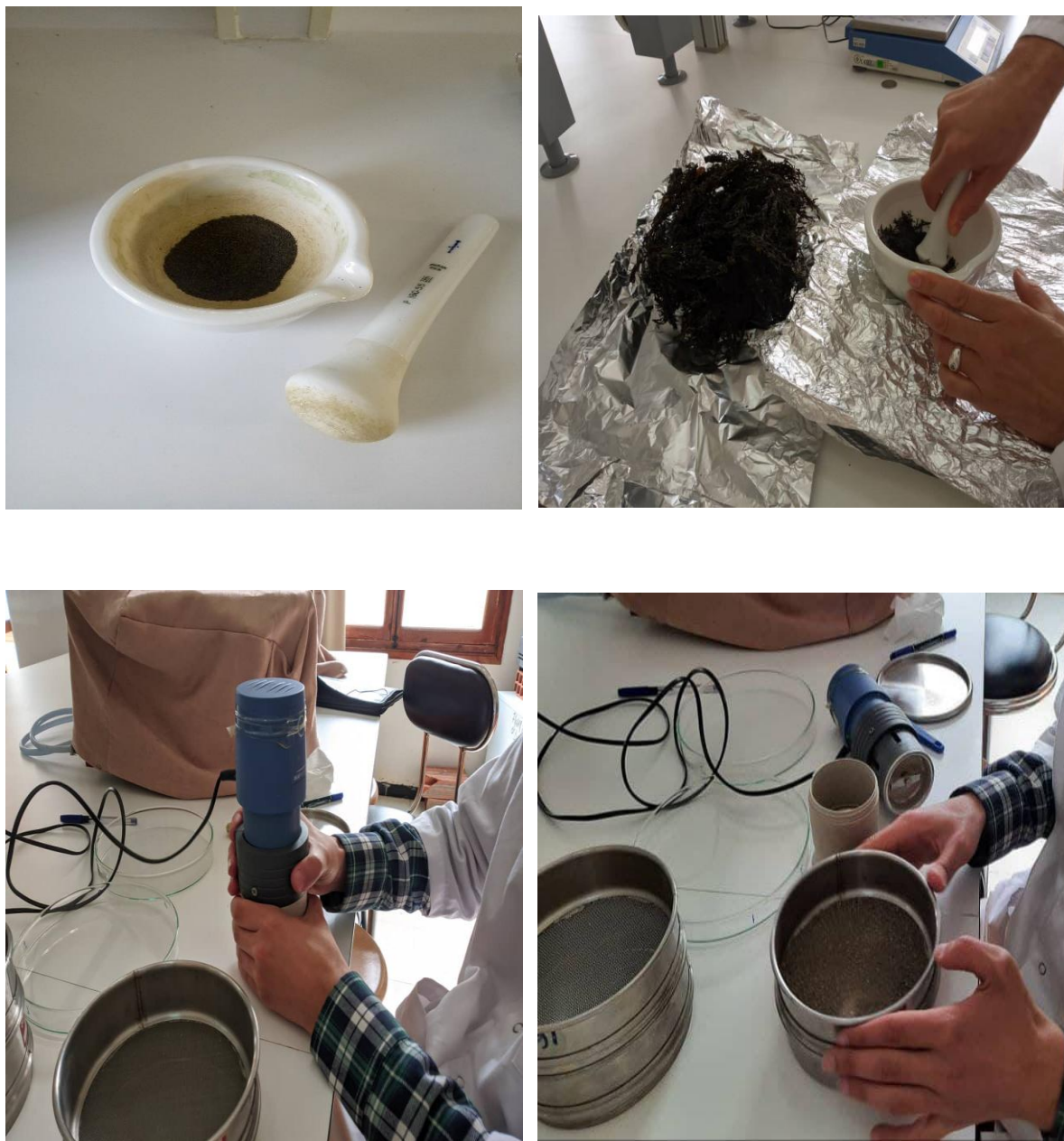
Figure 08 : Broyage et Tamisage d'Echantillon
