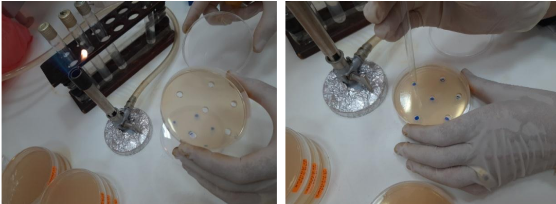
Figure 15 : Réalisation des puits sur gélose MH
