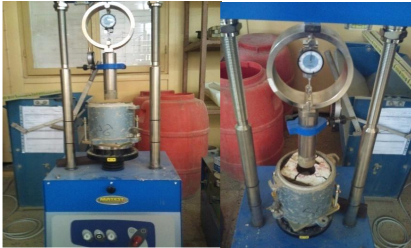
Photo VIII.2. Appareillage de l'essai CBR.
