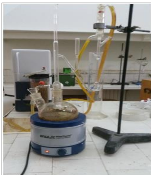
Figure 28 : Montage d'hydrodistillation type Clevenger (Photo originale, 2020).
