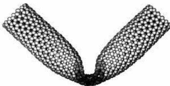
Figure I.7 : Contrainte mécanique qui induit une flexion dans un nanotube de carbone (Nguyen 2013)
