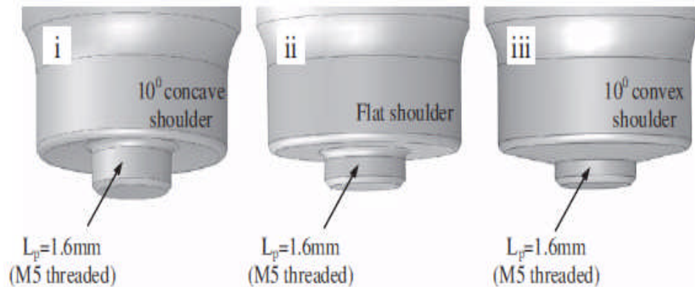
Figure 32 : outils avec pion cylindriques ayant (i) concave, (ii) plate et (iii) convexe [61].
