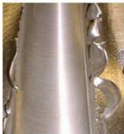
Figure 13: Bavures excessives le long du joint (« Ribbon flash ») [25].
