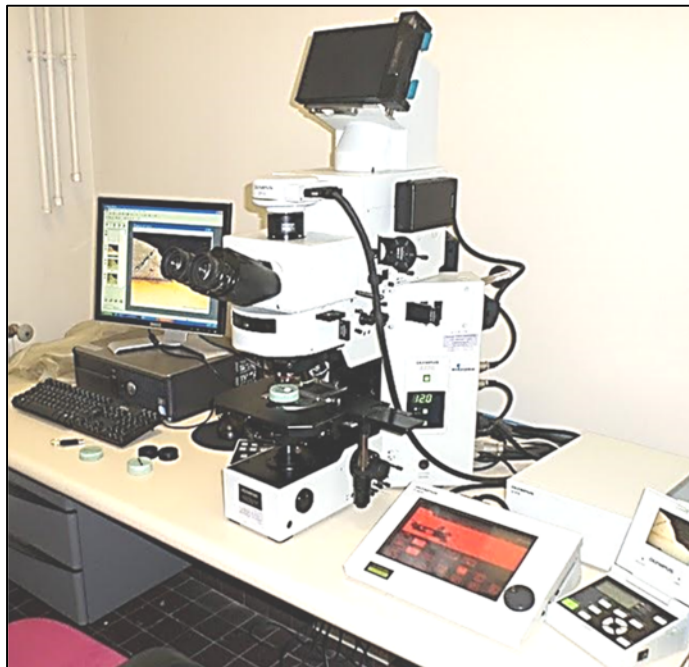
Figure 90 : Microscope optique à balayage utilisée (MEB, Olympus AX70).
