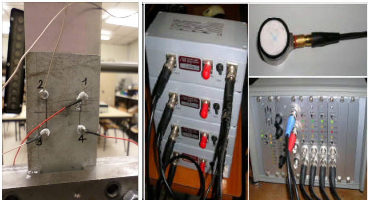
Figure 87 : Essai de traction-cisaillement avec le dispositif de l'émission acoustique.
