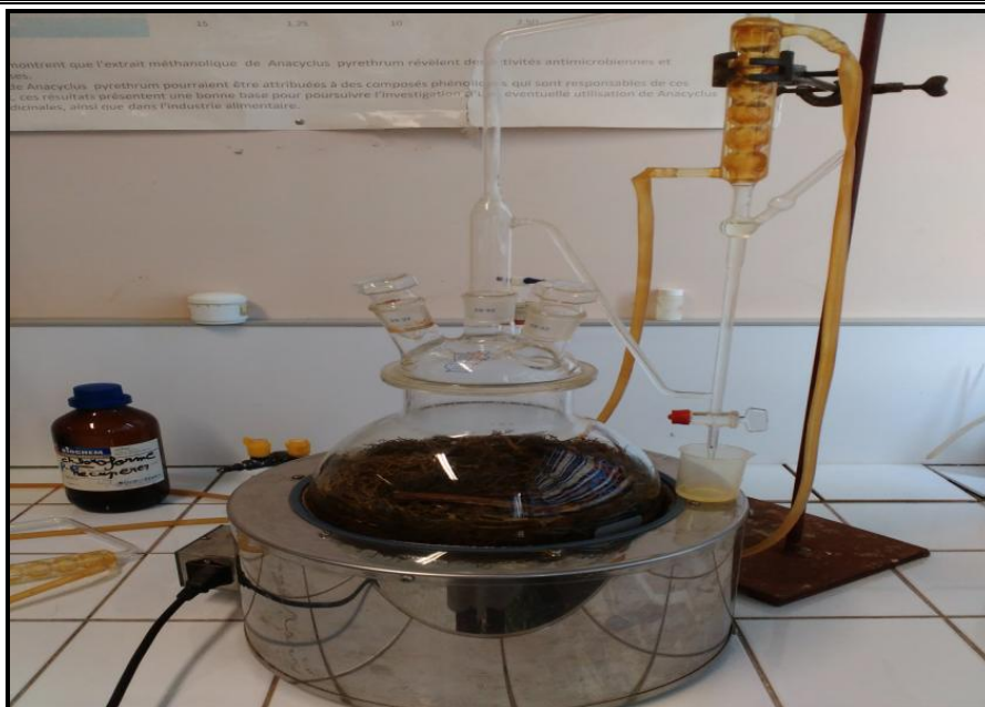
Figure 2 : Montage de l'hydrodistillation type Clevenger.
