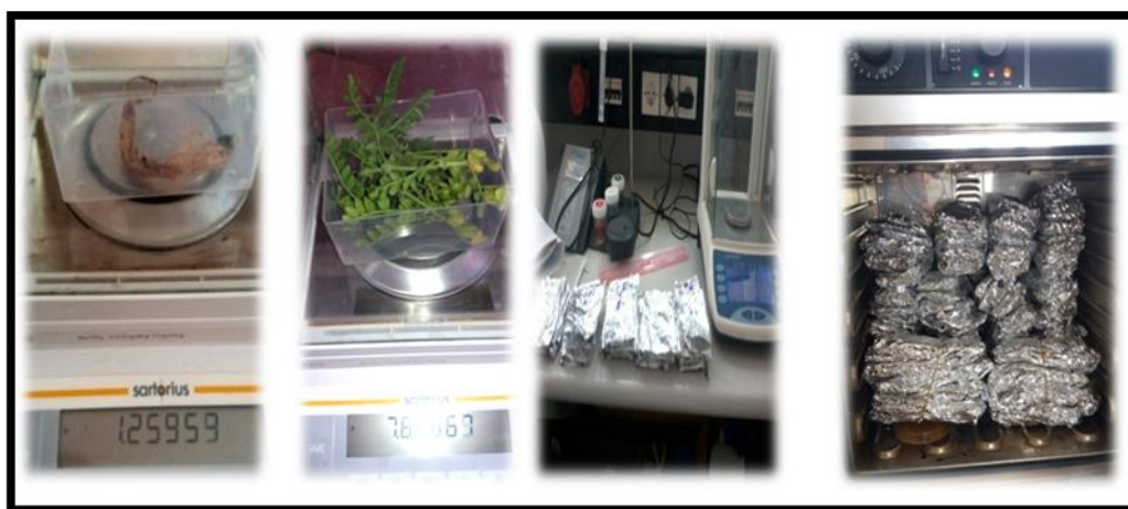
Fig.54. Détermination du poids frais et du poids sec des parties aériennes et racinaires.
