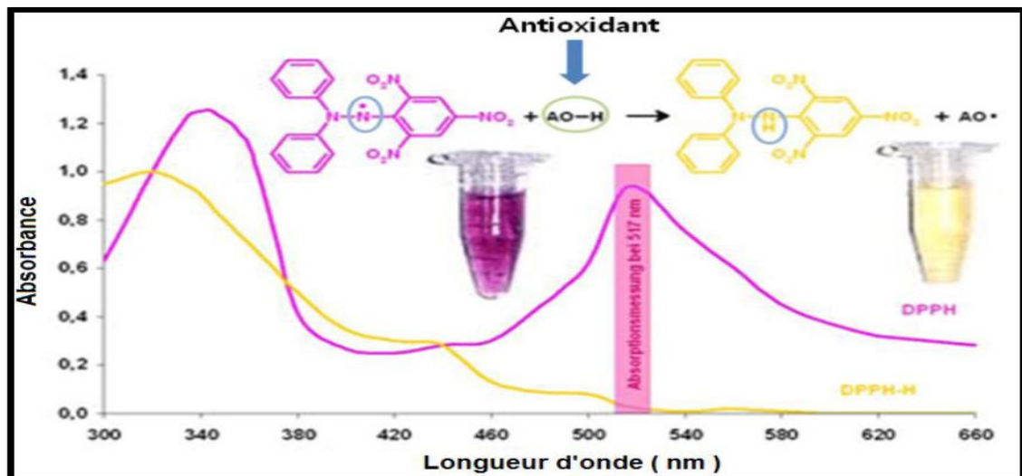
Fig.64. Structure du DPPH avec sa forme libre et réduite (Dangles et al. , 2000).
