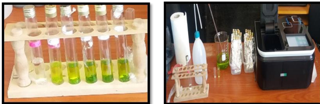
Fig.57. Dosage de la chlorophylle a, b, totale et des caroténoïdes à l'aide d'un spectrophotomètre à UV
