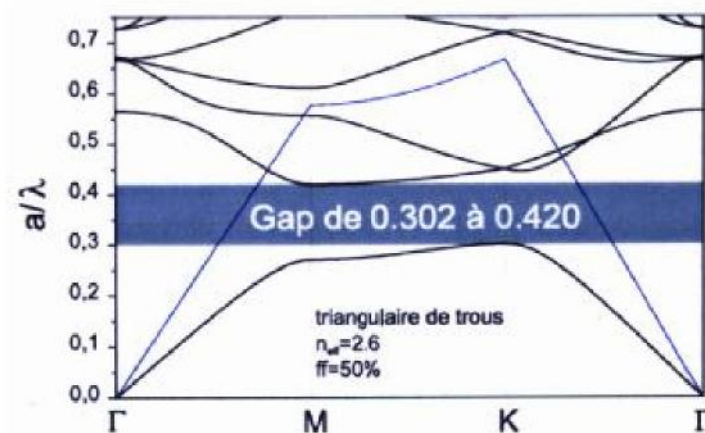
Figure 2.2 : Diagramme de bandes du cristal photonique triangulaire de trous d'air sur membrane suspendue par la méthode de l'indice effectif (calcul 2D) pour un facteur de remplissage de 50%, dans un matériau semi-conducteur n=3,2 ( n_{ef}=2,6 ). Source GES
