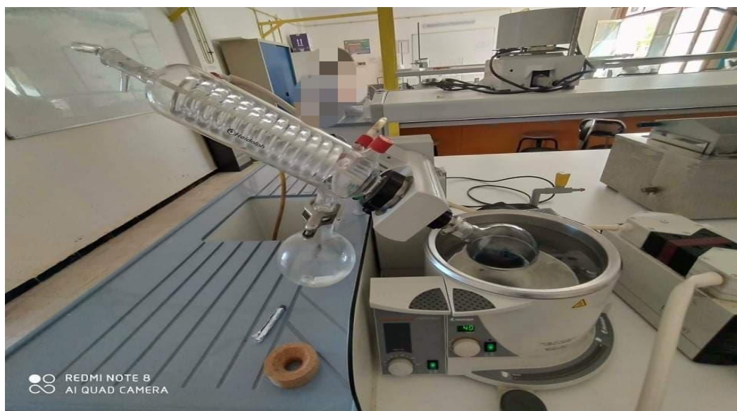
Figure 22 : La technique de séparation par Rotavapeur (photo prise par AMICHI)
