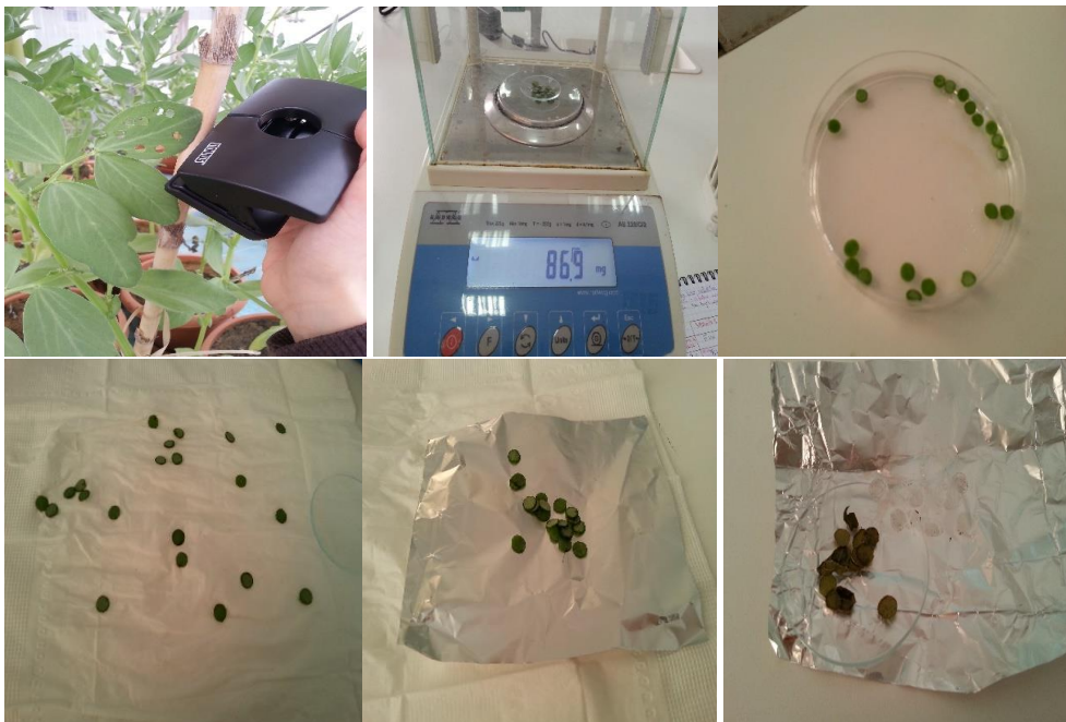
Figure 35 : Détermination de la teneur en eau relative (TER) des feuilles de Histal et Super Aguadulce ( Vicia faba L.)
