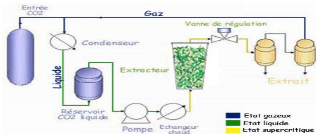
Figure .23 : L'extraction au CO 2 supercritique (Willem, J.P.,2002)
