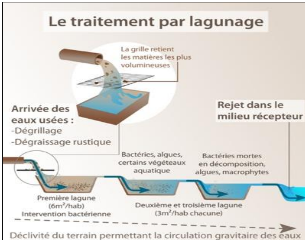
Figure 9. Épuration par lagunage naturel 11
