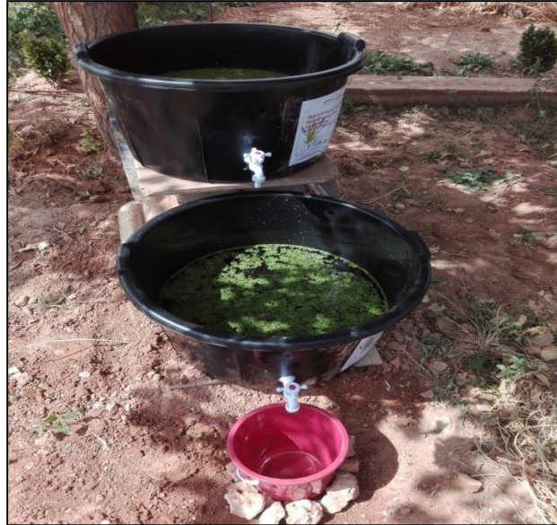
Photo 3. Site aménagé pour la phytoépuration, ONA/Mécheria (Chadli, 2017).
