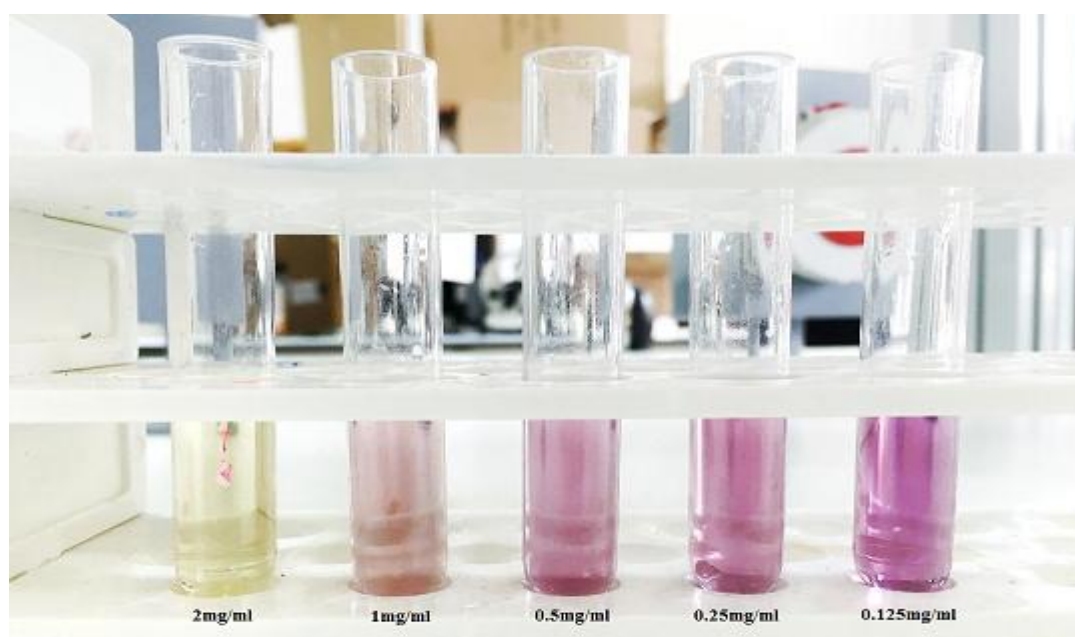
Fig25. Réaction d'inhibitions du radical libre de DPPH.
