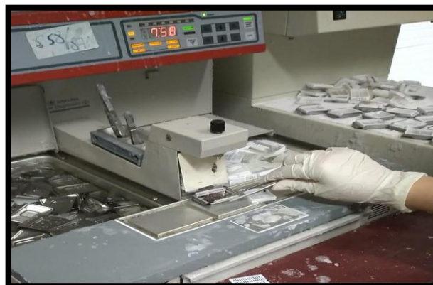
Figure 4.10 : groupe thermoélectrique pour le paraffinage.
