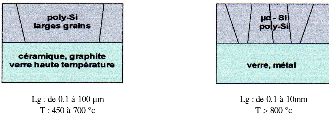
Figure I.14 : Différentes voies d'obtention de film silicium sur substrat étranger [22].
