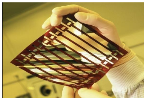
Figure I.20 : Cellule solaire tout organique sur substrat souple [8].
