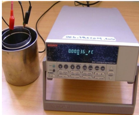
Figure III.16 Electromètre Keithley model 6514 utilisé pour la mesure.
