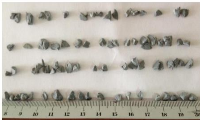
Figure III.13 Physionomie et taille des granules PVC
