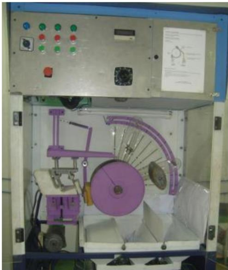
Figure I.22 Photographie de l'électro-séparateur réalisé au laboratoire IRECOM [59]
