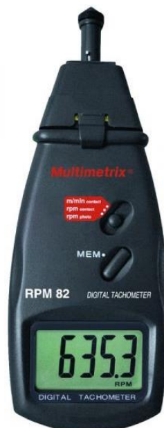
Figure III.19 Tachymètre numérique RPM 82
