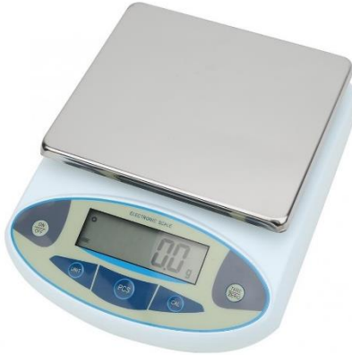
Figure III.17 Balance numérique de précision 0.1: 600g
