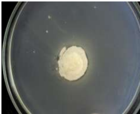
Photo 10 : zone d'hydrolyse entourant la poly- \epsilon -caprolactone.
