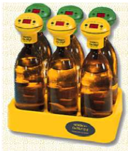
Figure 1 : Appareil pour mesure de la DBO 5
