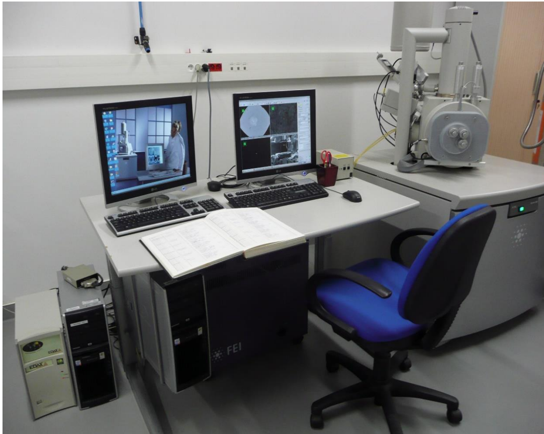
Figure 4.7 Dispositif microscopie électronique à balayage «Env. SEM, Quanta 400 FEI» Laboratoire SRO - IFSTTAR
