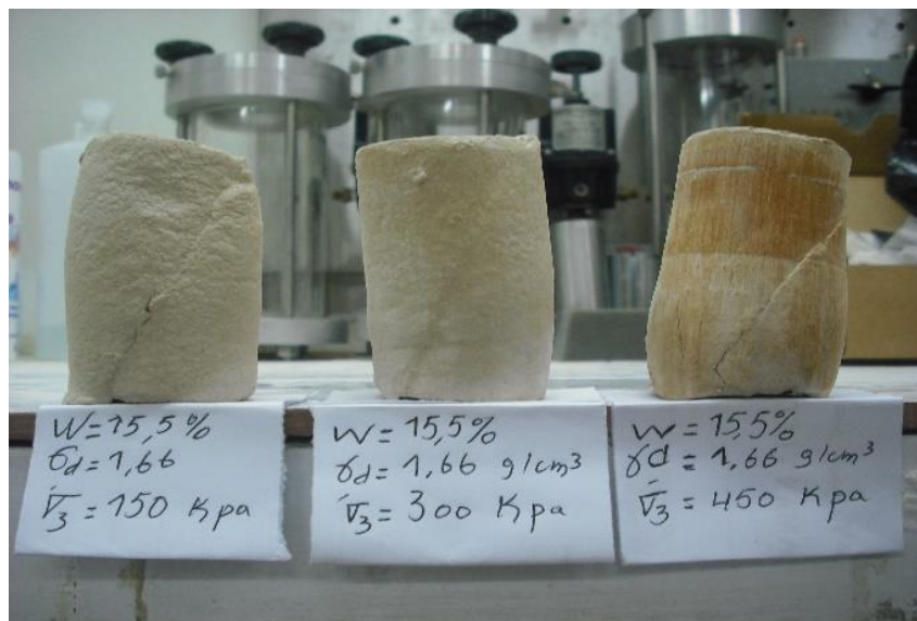
Figure 5.6 Des échantillons du tuf calcaire compactée a l'OPM après cisaillement -essais CD
