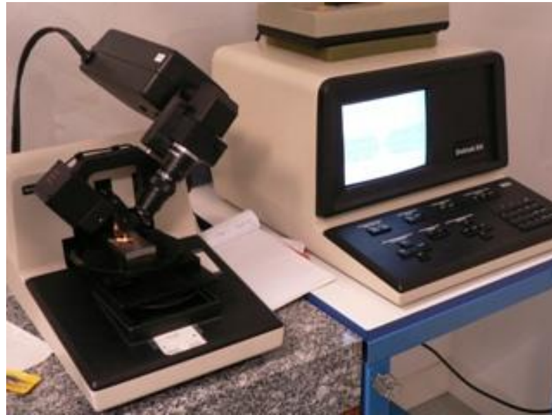
Figure V-5. Image du profilomètre 1D Dektak II A, montrant à gauche le stylet, à droite le moniteur d'enregistrement de profil
