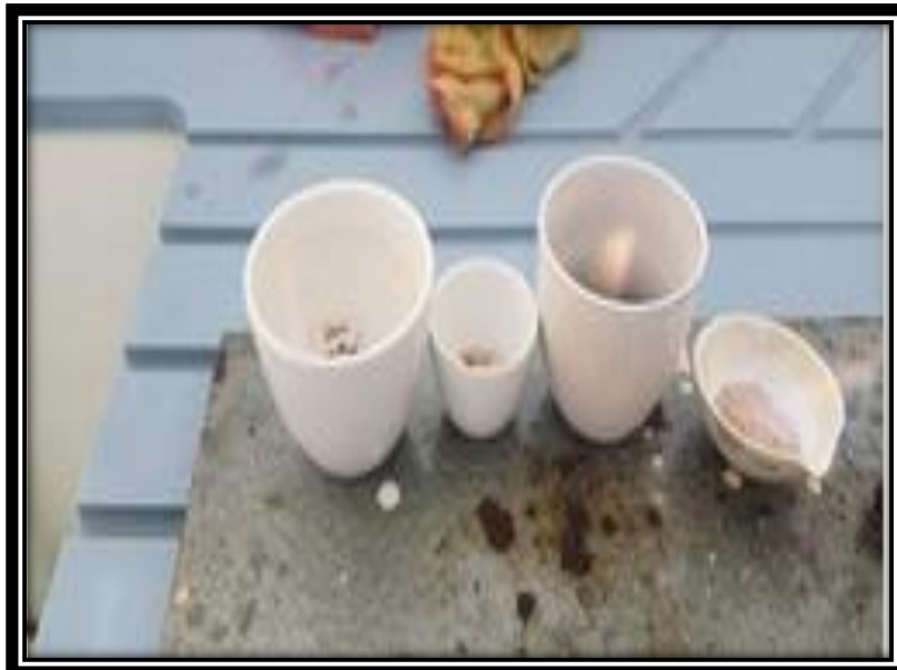
Figure 09 : La pré-incinération (l'ajout d'éthanol pour enflammer l'échantillon
