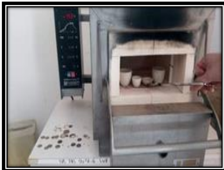
Figure 17 : Four à moufle électrique
