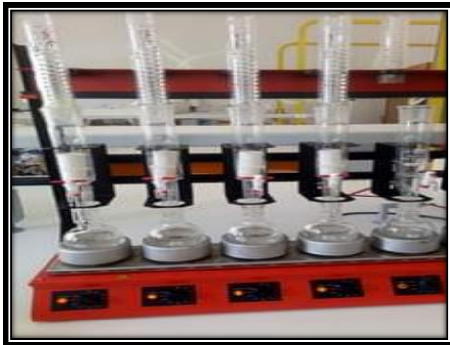
Figure 11 : ébullition et l'extraction est maintenue continuellement durée de 4 heures
