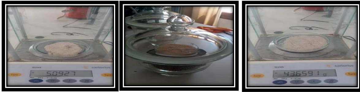
Figure 07 :L'échantillon avec la coupelle avant séchage, refroidissement de l'échantillon, après séchage
