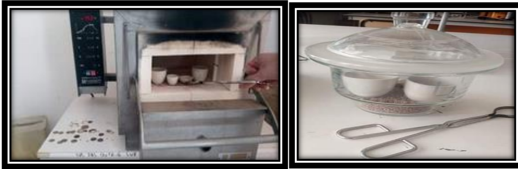
Figure 10 : L'incinération et refroidissement des capsules retirées du four
