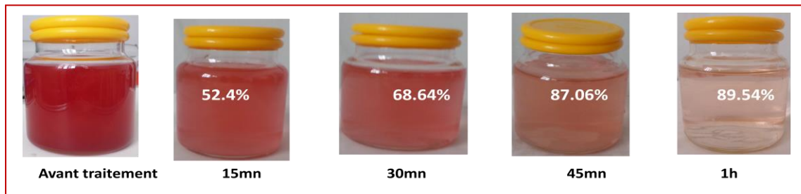
Figure 3.14. Décoloration d’une eau infectée par un seul colorant textile.
