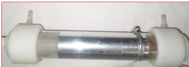
Figure 2.6. Photographie du réacteur d'ozone à DBD surfacique
