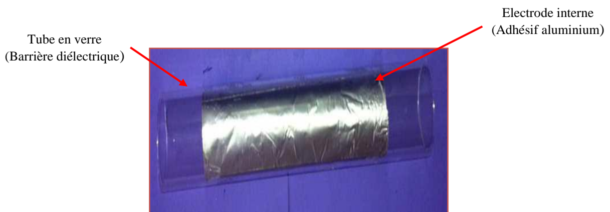
Figure 2.1. Photographie d’une électrode interne en aluminium adhésif insérée à l’intérieur de la barrière diélectrique en verre.
