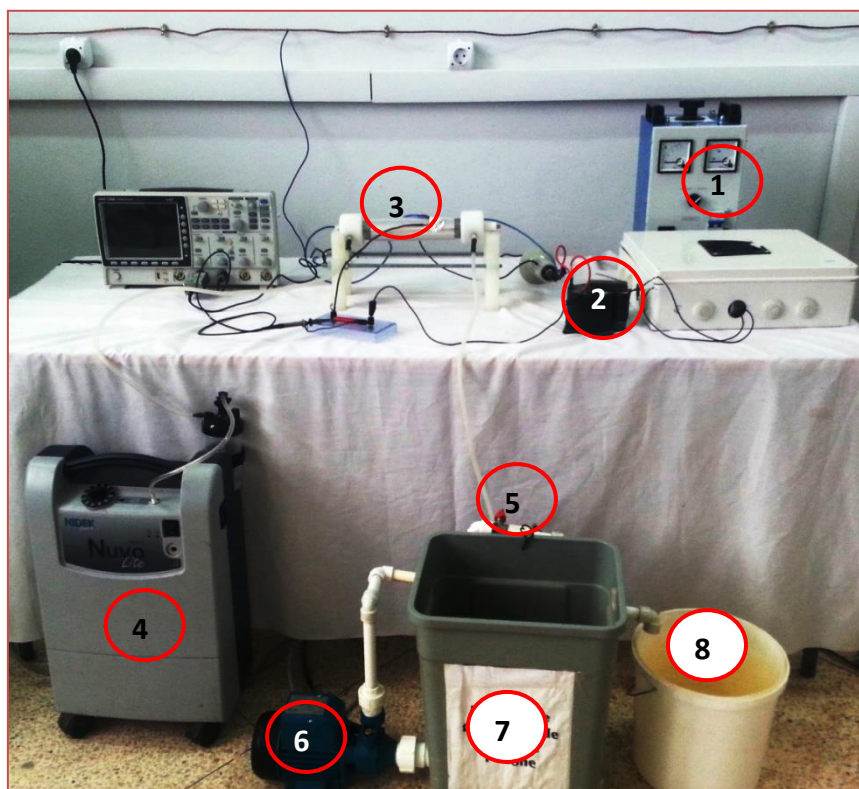
Figure 2.8. Dispositif expérimental utilisé pour le traitement des eaux
