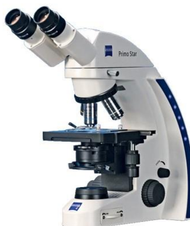
Figure 13 : Microscope binoculaire de Routine ZEISS Primo Star 1000 de 04 Objectifs (site web 2)
