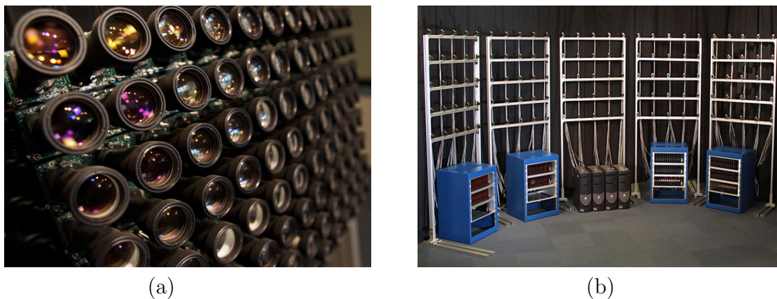
FIGURE 1.2 – Exemple d'un système d'acquisition des light field. (a) représente un mur du système d'acquisition des light field. (b) représente le système d'acquisition des light field constitué de plusieurs murs de caméras, image extraite de [45]
