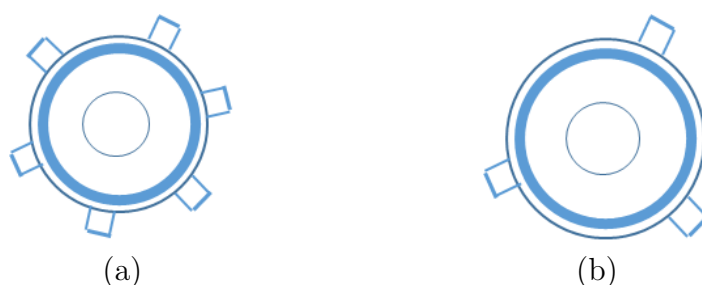
FIGURE 4.3 – Illustration de l'effet négatif du sous échantillonnage sur la capture du contour de l'objet. (a) représente un contour bien échantillonné. (b) représente un contour sous échantillonné.
