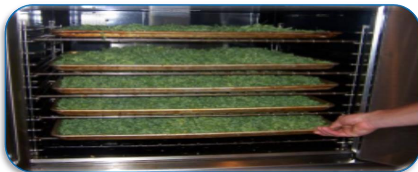
Figure 18 : Séchage mécanique à l'aide des séchoirs à air chaud. file:///C:/Users/Admin/Desktop/Downloads/tn-51-poudre-de-feuilles-de-moringa
