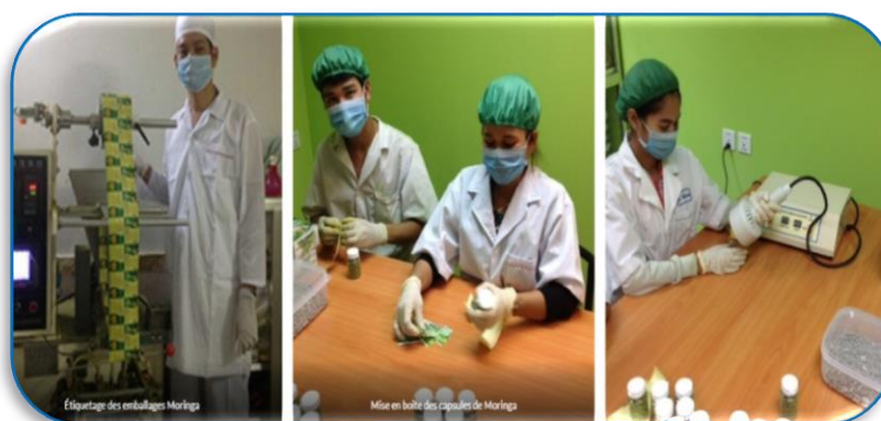
Figure 20 : Machine pour étiqueter les emballages, et mise en boîte manuelle avec pesage et mise sous vide pour préserver les vitamines du Moringa .
