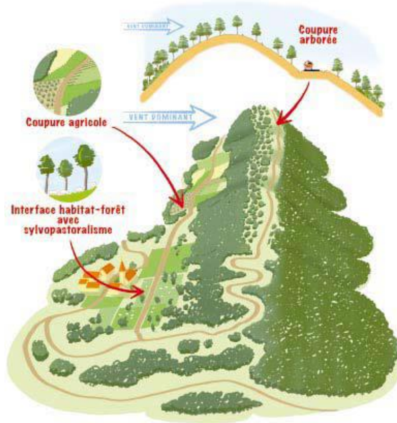
Figure 15: Modèles de coupures anti-incendie (Source : réseau coupure de combustible, 1999 in Clément, 2004 )
