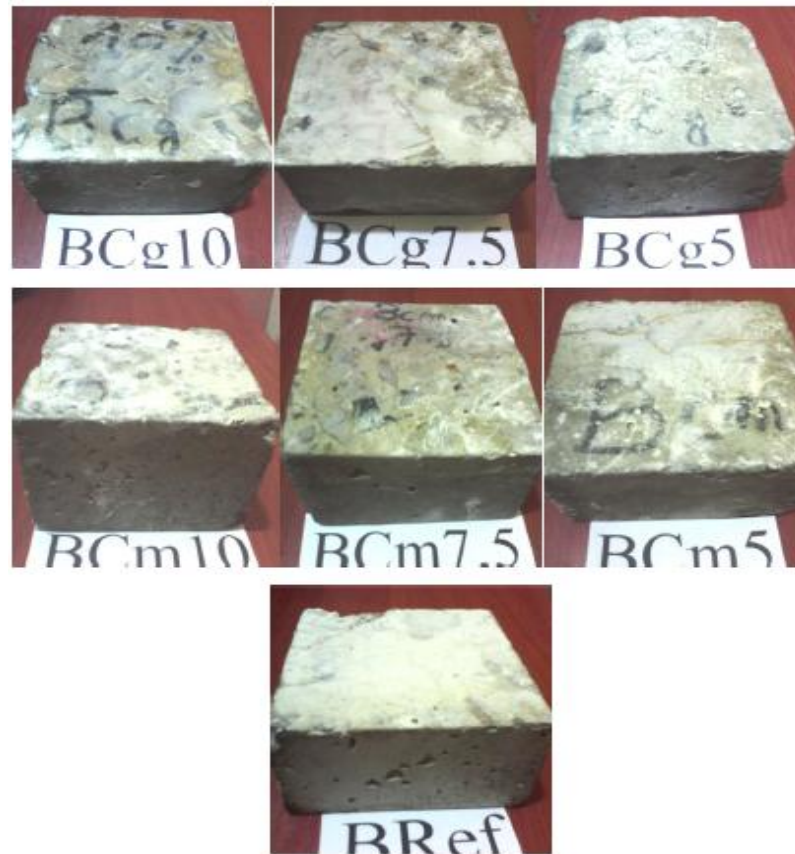
Figure 4.11 Etat des éprouvettes après 90 cycles d'immersion dans une solution de 5% d'acide de \text{Na}_2\text{SO}_4 [Med17]
