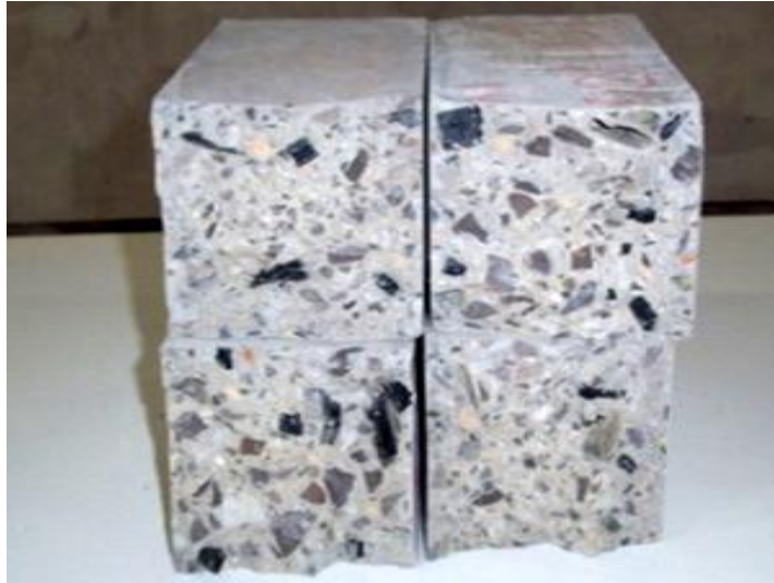
Figure 3.6 Epreuves prismatique soumises aux essais de traction par flexion en 04 points à 28 jours [Med11].
