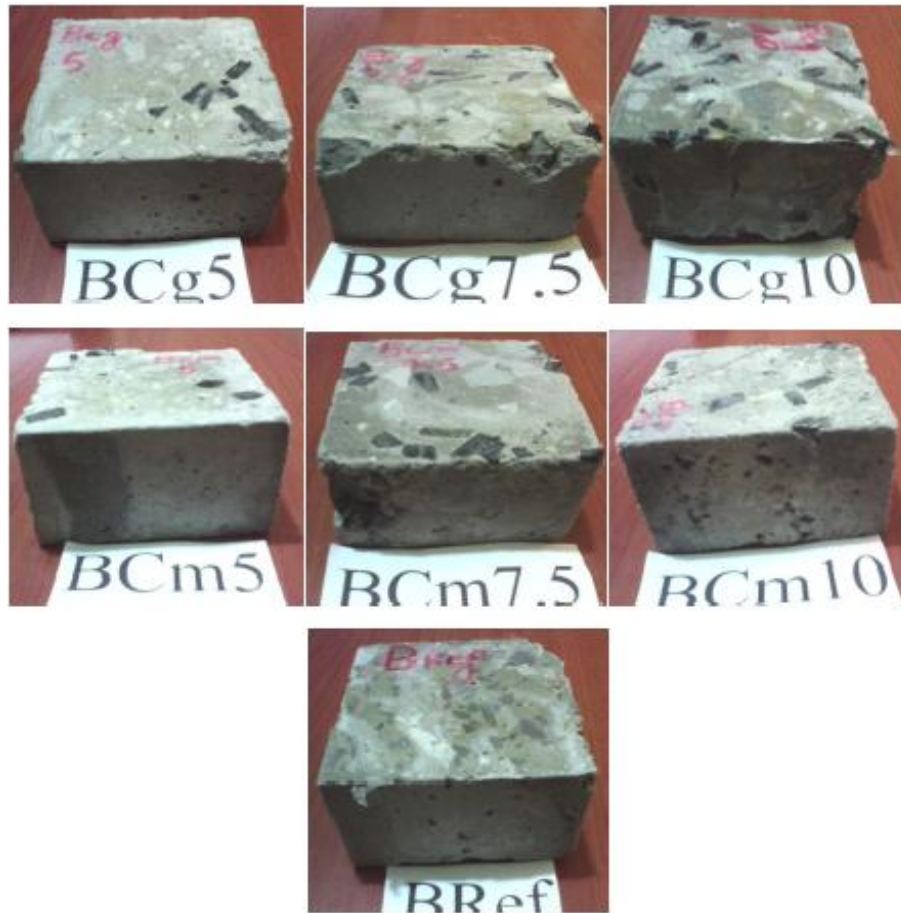
Figure 4.2 Etat des éprouvettes après exposition à 35 cycles de gel-dégel.
