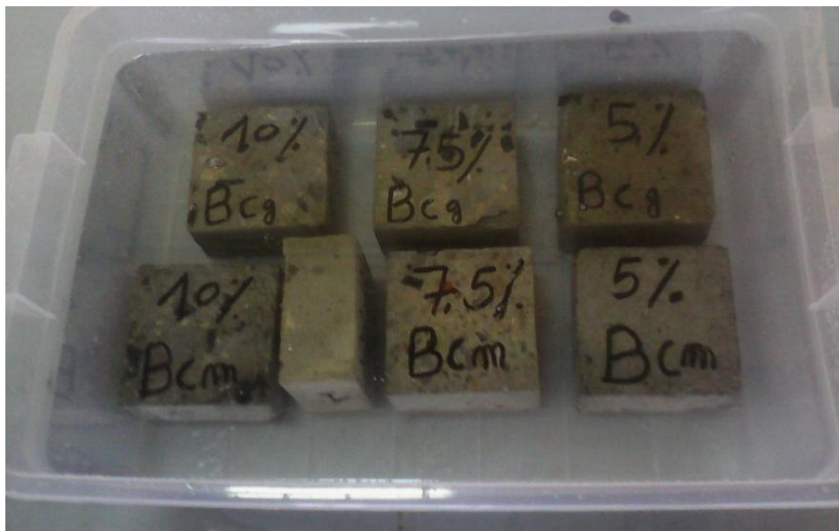
Figure 4.33 Des éprouvettes de bétons légers immergées dans l'eau.
