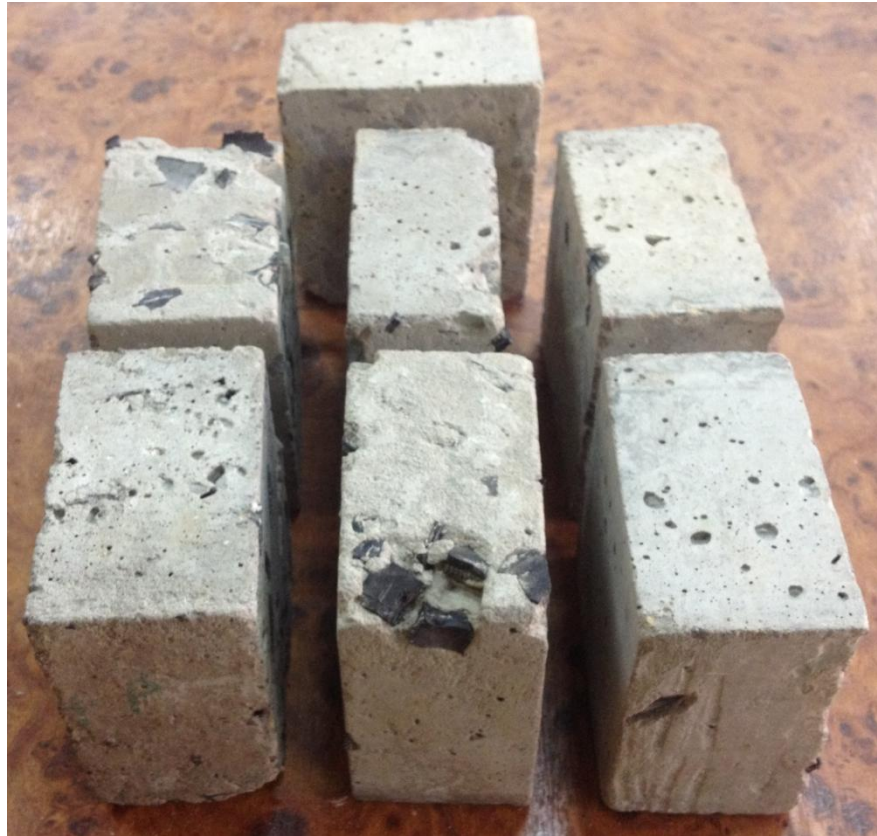
Figure 4.5 Etat des éprouvettes après 100 cycles de gel-dégel [Med17]
