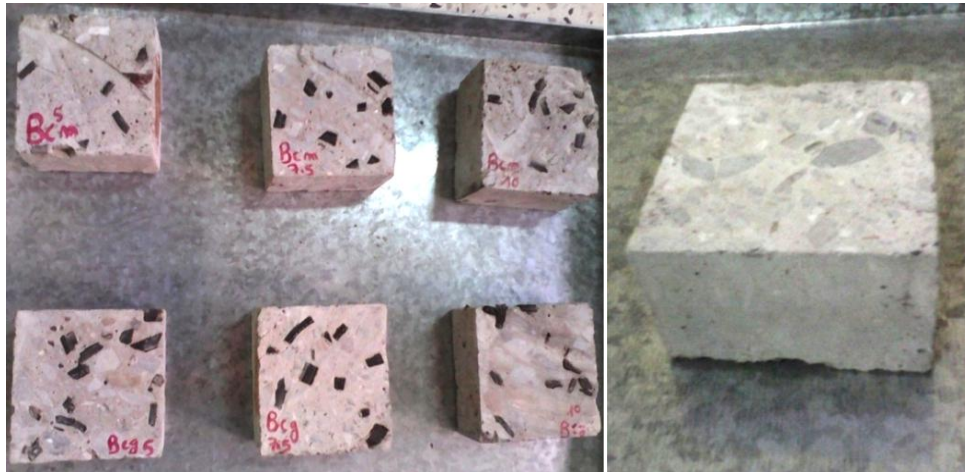
Figure 4.28 Epreuve de bétons légers caoutchoutés et béton léger de référence chauffés à 200°C.
