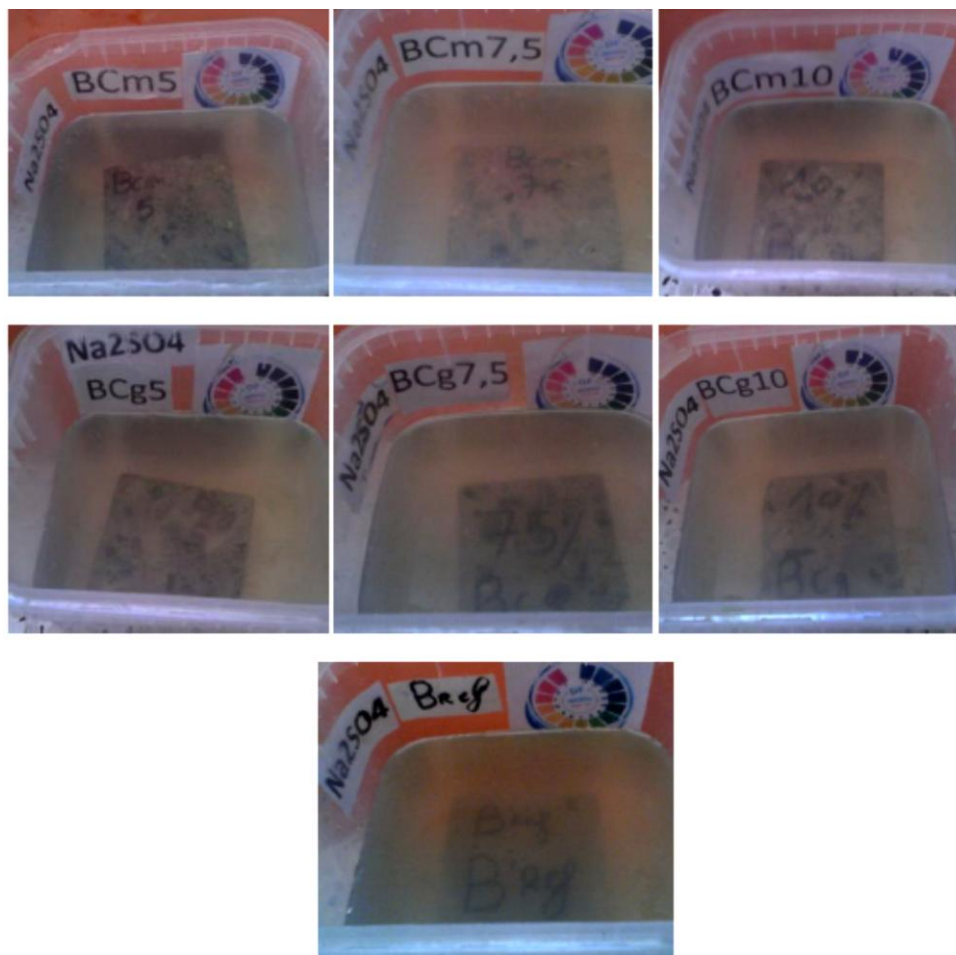
Figure 4.12 Solution de l'acide \text{Na}_2\text{SO}_4 contenant des éprouvettes pour mesure du pH.
