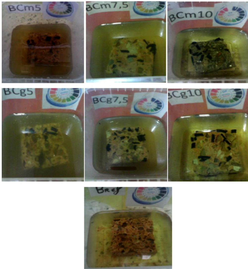
Figure 4.18 Le suivi de l'évolution du pH de la solution de 5% d'acide chlorhydrique (image correspondante à 85 cycles).
