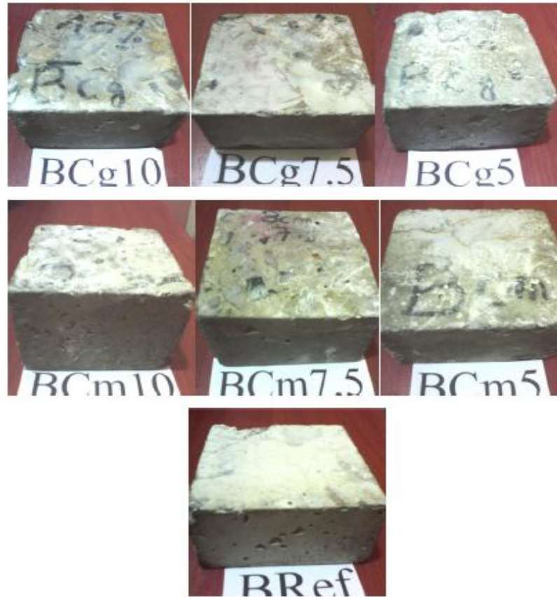
Figure 4.10 Eprouvettes après 60 cycles d'immersion dans une solution de \text{Na}_2\text{SO}_4
