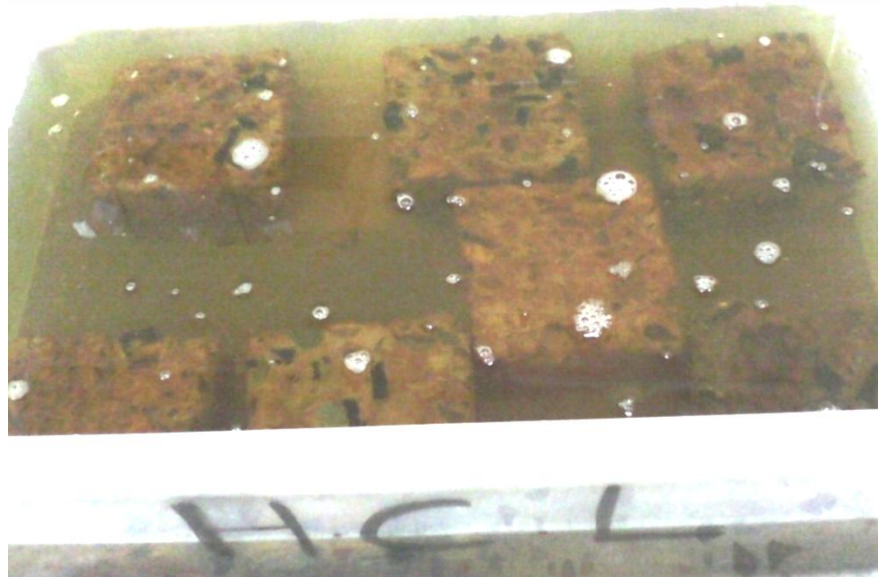
Figure 4.13 Éprouvettes immergées dans la solution de l'acide chlorhydrique (HCl).
