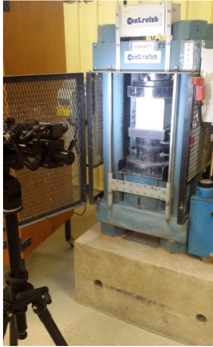
Figure 4.7 : Machine de compression associée au système de mesure 3D de déformations sans contact par stéréo-corrélation d'images ARAMIS.
