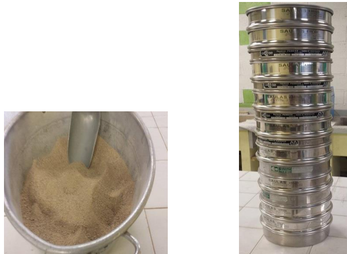
Figure 4.1 : Sable employé et série de tamis utilisés pour l'analyse granulométrique.
