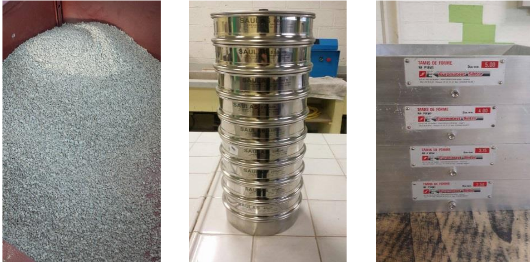
Figure 4.3 : Gravier utilisé et série de tamis pour la granulométrie et le module d'aplatissement.
