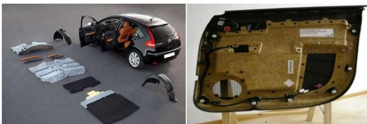
Figure I.12 : Intérieur de portière Mercedes à base de fibres de chanvre.
