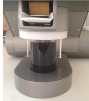
l'absorption d'iode par une suspension diluée de farine.
