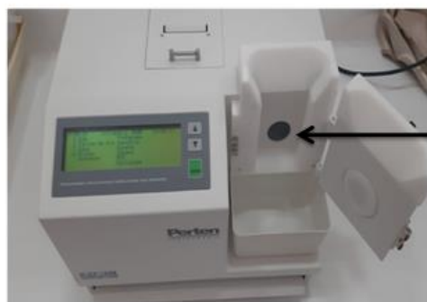
Figure 13: l'INFRAMA TIC utilisé pour obtenir le taux de protéines.
