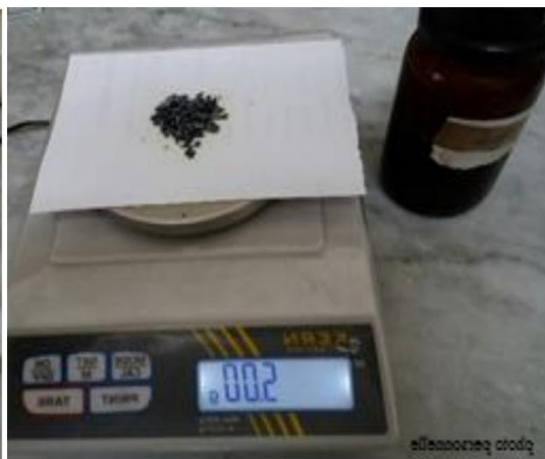
Figure 22 : Peser 5 g d'iode métalloïdique. Figure 21 : Peser 10 g d'iodure de potassium
