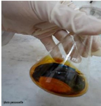
Figure 25: Ajouter l'iodure de potassium. Figure 26 : Bien mélanger.
