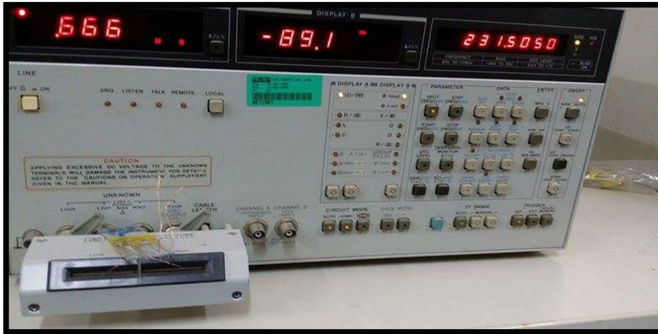
Figure V.3 : impédance-mètre modèle HP4192 relié par l'accessoire 16047A.
