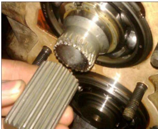
3- Rupture d'un arbre cannelé
