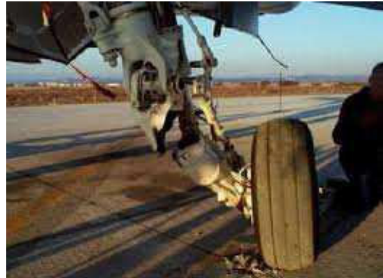
2- Fissuration au niveau du mécanisme d'atterrissage d'un avion
