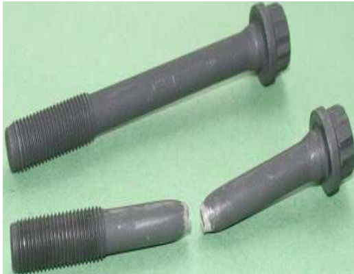
1- Rupture d'un tirant
