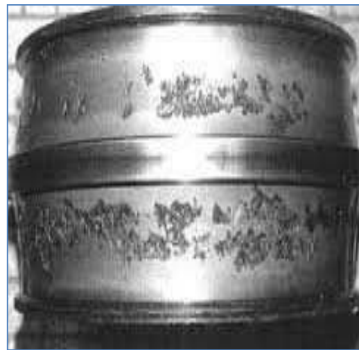
Figure I.14. Détérioration d'une bague de roulement.
