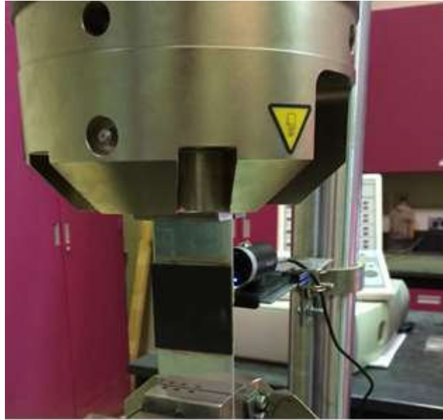
Figure III-3: Photo de l'éprouvette réparée montée sur la machine de fatigue
