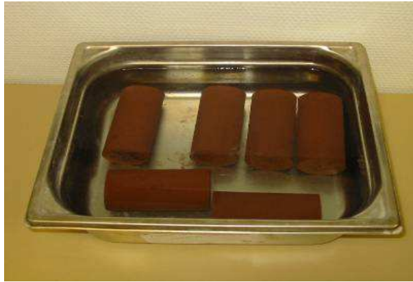
Figure IV.13 : Immersion des éprouvettes destinées à la détermination de Rci
