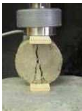
Figure IV.15: Illustration de l'essai de compression diamétrale
