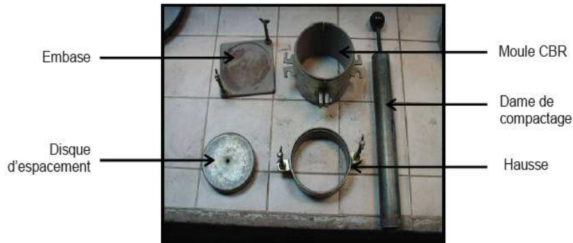
Figure III. 16: Matériel de l'essai Proctor Normale
