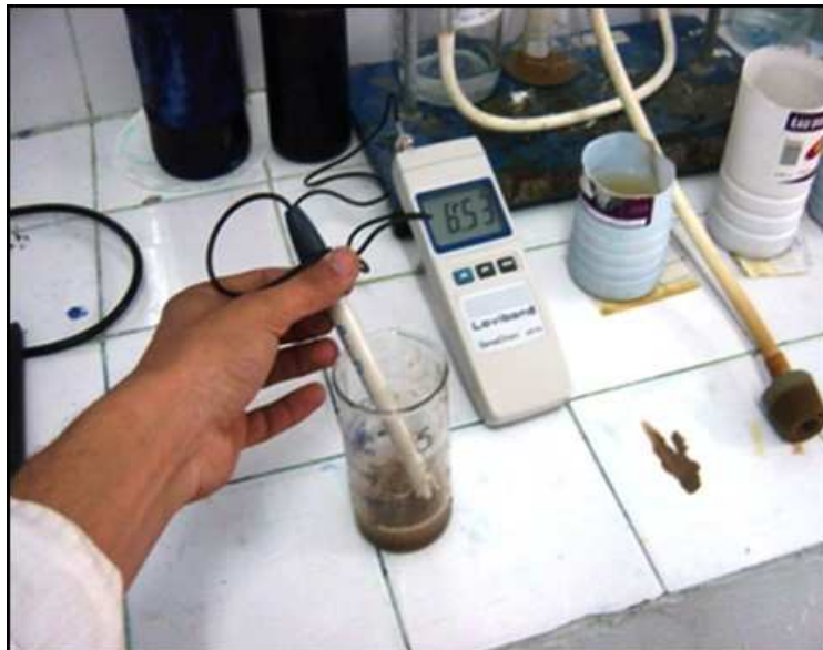
Photo III.9 : Mesure de l'acidité de sédiment de drague par un appareil de pH-mètre -LTPO-
