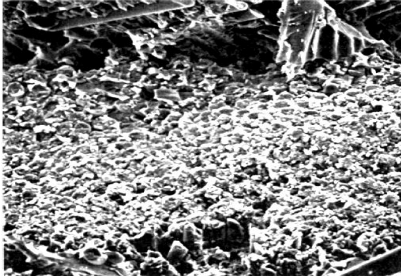
Fig. II. 27 : Faciès de rupture par micro-flambage.
